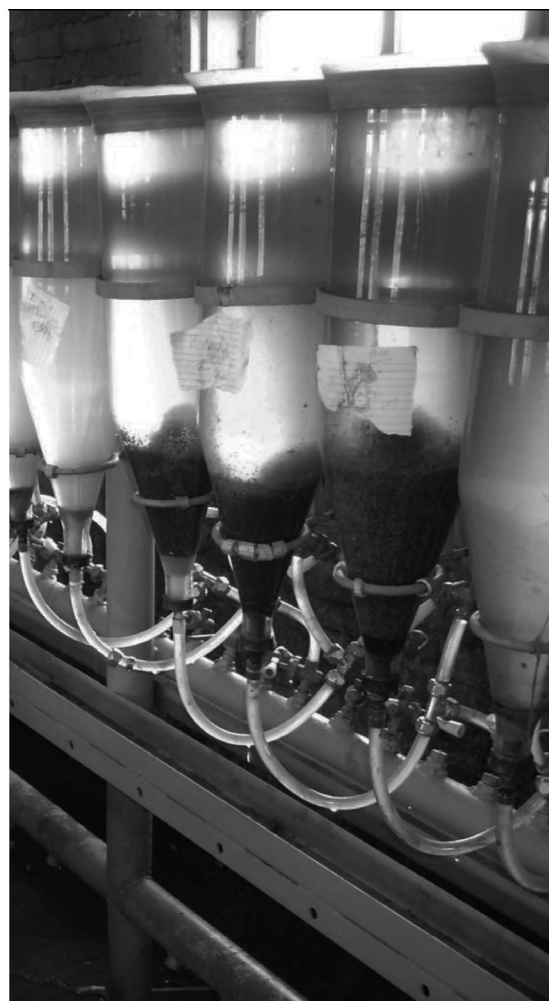
Рис. 2. Инкубация икры в аппаратах Вейса
