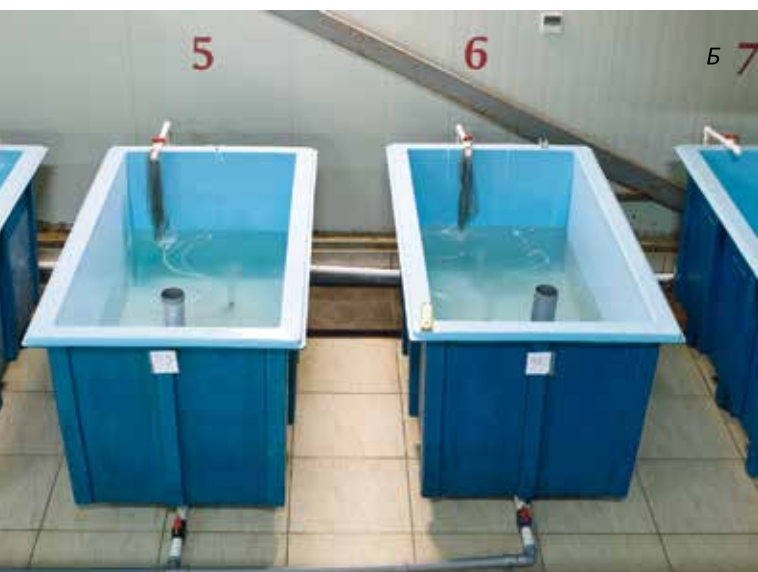
Рисунок 1. Выростные емкости: А - с рабочим объемом 200 л; Б - с рабочим объемом воды 1 м 3
