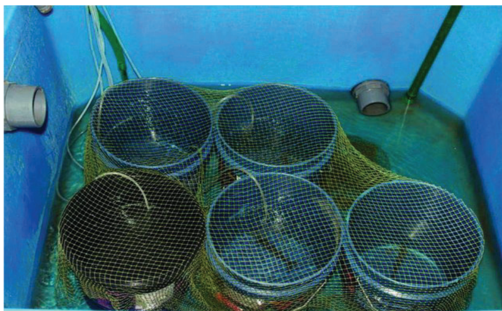
Рис. 1. Экспериментальные емкости с креветками, установленные в термостатирующем бассейне
