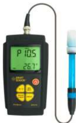
Рисунок 3 – Электронный pH-метр AR218
