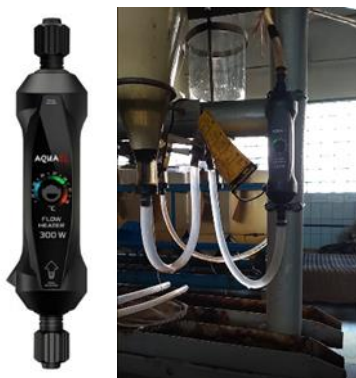
Рисунок 2. Система проточного подогрева воды.
