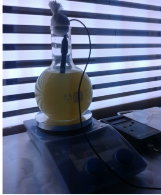
Рисунок 3.14 — Экспериментальная установка по культивированию Cyindrotheca closterium с использованием бикарбоната как единственного источника углерода
