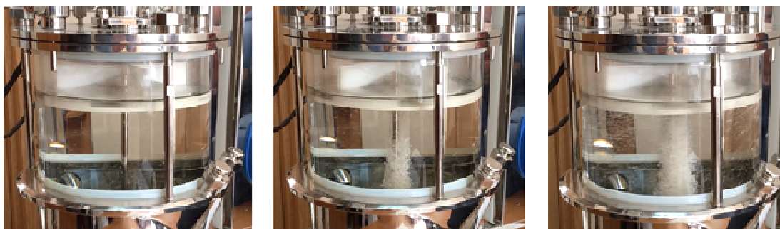
Рисунок 5.3 — Общий вид лабораторного газовихревого фотобиореактора, объём 5 л. Показано появление вихря в суспензии [7]
