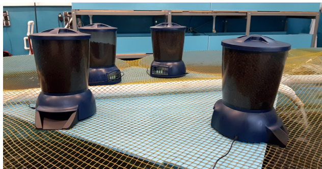
Рис. 3 – Автоматические кормушки для кормления посадочного материала карпов (сеголетков) в основном УЗВ
