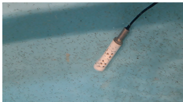
Рис. 2 – Личинки карпа в ёмкости мини УЗВ «Рачительная». Осуществляется контроль температуры и содержания кислорода в воде.
