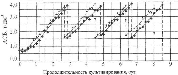
Рис. 6. Зависимость роста биомассы хлореллы от времени при шаге витков спирали, мм: —◇— 10 ( d_{wk}=1,4 мм); —▲— 15 ( d_{wk}=2,1 мм)
