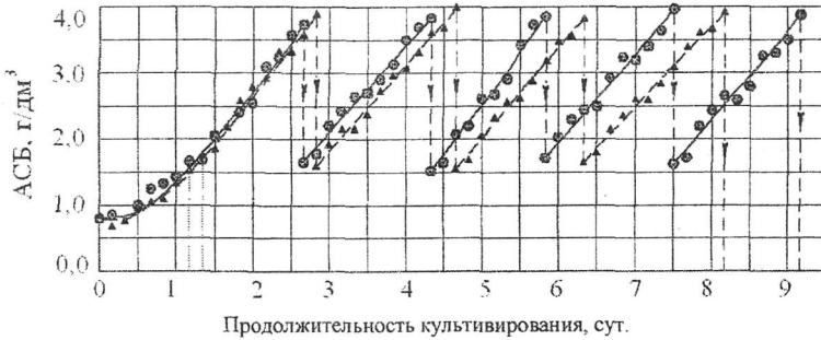
Рис. 5. Зависимость роста биомассы хлореллы от времени при расходе суспензии, м 3 /ч: —○— 1,8 (Re=4550); —▲— 2,4 (Re=6070)
