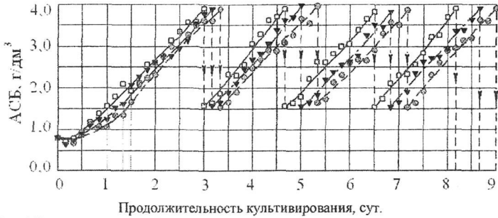
Рис. 4. Зависимость роста биомассы хлореллы от времени при освещенности, клк: —○— 11,3; —▼— 15,6; —□— 28,3
