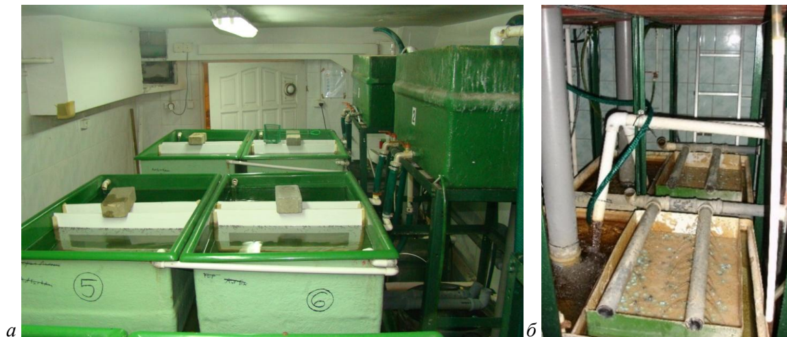
Рисунок 3 — а — бассейны для подращивания личинок осетра в УЗВ (г. Ольштын); б — фильтры для биологической очистки воды в УЗВ
