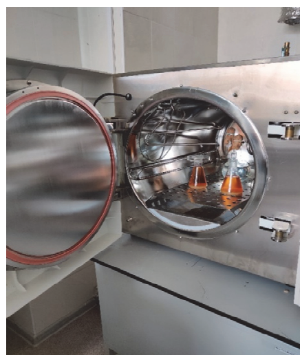
Рисунок 2 – Стерилизация среды в автоклаве
