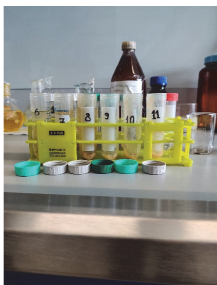
Рисунок 4 – Подготовка образцов к перевариванию в NaOH
