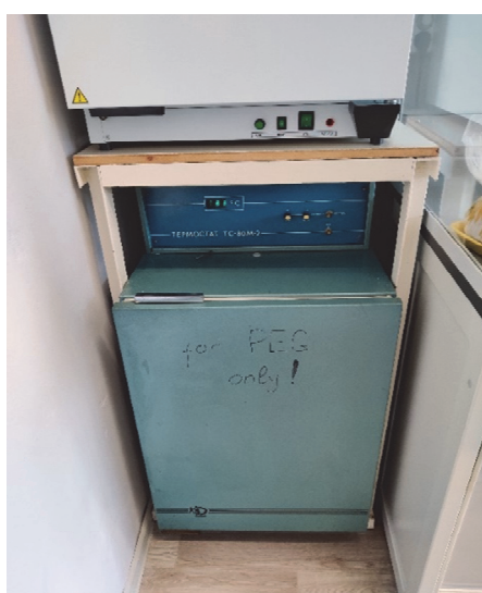
Рисунок 3 – Термостат для инкубации моллюсков в среде
