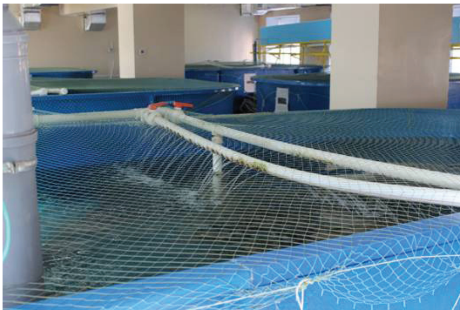
Рисунок 1 – Комплекс установок с замкнутым циклом водообеспечения
