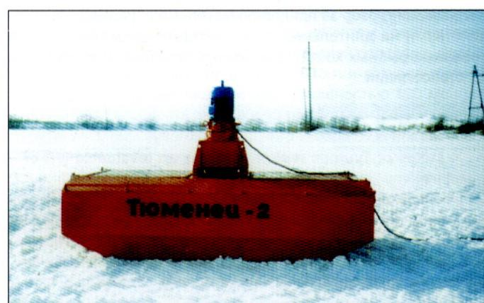
*Фото 2. Турбоаэратор «Тюменец-2» мощностью 2–3 кВт*
