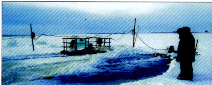
**Фото 5. Два турбоаэратора Н19-ИАК/1 на озере. В качестве отражателя использован берег озера. Потоки направлены под острым углом к оси отраженного потока**
