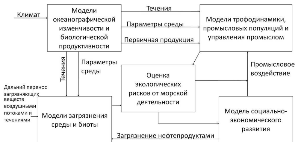
Рис. 8. Модульная структура математической модели БМЭ Баренцева и Белого морей
