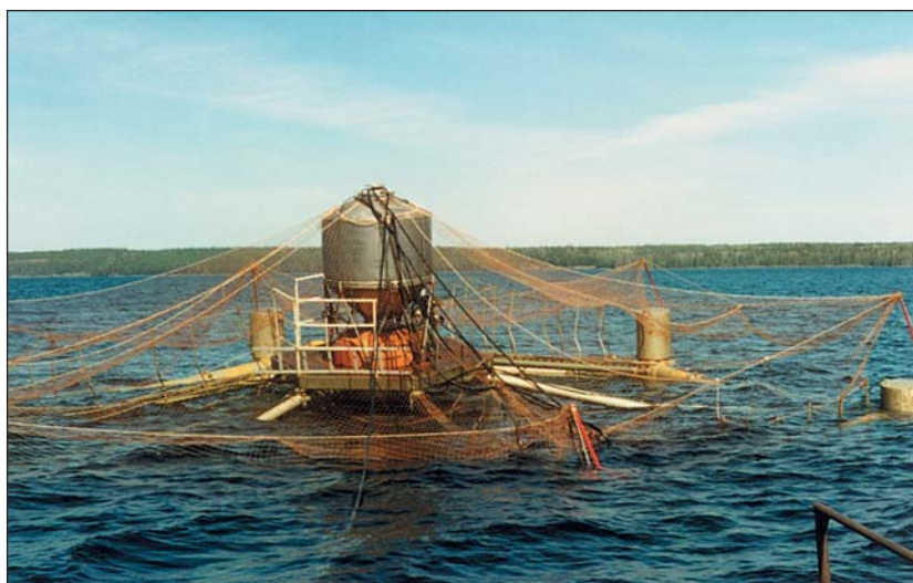
Автоматизированный рыбоводный садок ПАРС-2500 в надводном положении (вверху) и на плаву.
