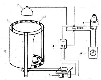
Рис. 1. А) Кольцевая гидродинамическая установка: 1 - сетка; 2 - ламинаризатор; 3 - двигатель; 4 - ось с винтом; 5 - ЛАТР; 6 - осветитель. Б) Оптомоторная установка: 1 - рабочий цилиндр; 2 - ширма; 3 - малооборотный двигатель; 4 - тиристорный регулятор; 5 - высокооборотный двигатель; 6 - ЛАТР; 7 - осветитель
