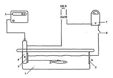
Рис. 2. Схема измерения физической силы рыб. 1 - лоток; 2 - анод; 3 - катод; 4 - датчик динамометра; 5 - регистрирующий блок; 6 - выключатель; 7 - вольтметр
