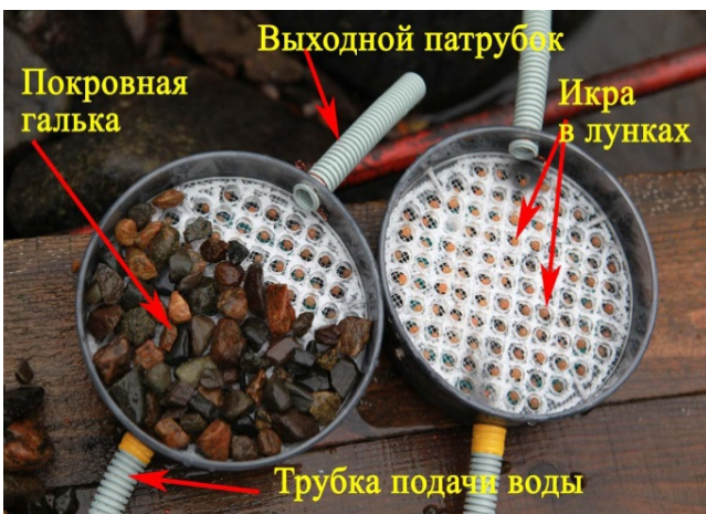
Рис. 2. Конструкция гнезда-инкубатора и установка его на дне реки
