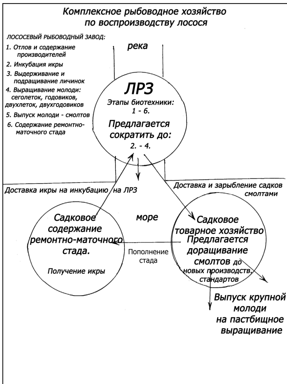
Рисунок 3 - Схема комбинированного рыбоводного хозяйства, включающая лососевый рыбоводный завод и садково-вырастные участки выращивания крупной смолтифицированной молоди и ремонтно-маточного стада в солоноватой морской воде
