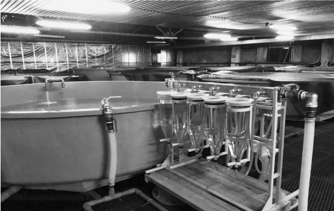
Рис. 1. Инкубационные аппараты Вейса на Ольской экспериментальной производственно-акклиматизационной базе
