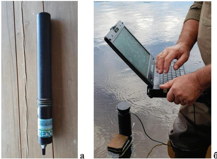
Рис. 7. Внешний вид гидроакустических буев (а) и их установка в реке (б)
