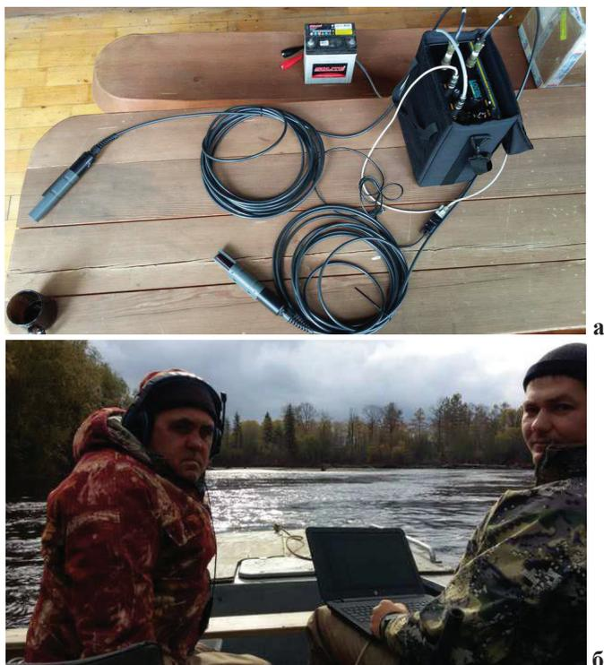
Рис. 6. Мобильное оборудование для приема сигналов от акустических меток (а) и поиск гидроакустических сигналов при помощи компьютерной системы и наушников (б)
