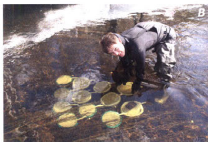
Рис. 3. Испытание гнезд-инкубаторов с выносным (а, б) и прижимным (в) водозаборниками на реках Лижма и Суна. Личинки лосося из гнезд р. Лижма (г)
