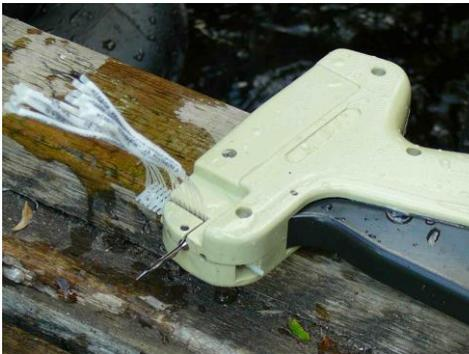
Рис. 2.4. Пистолет для мечения Т-образными метками с обоймой
