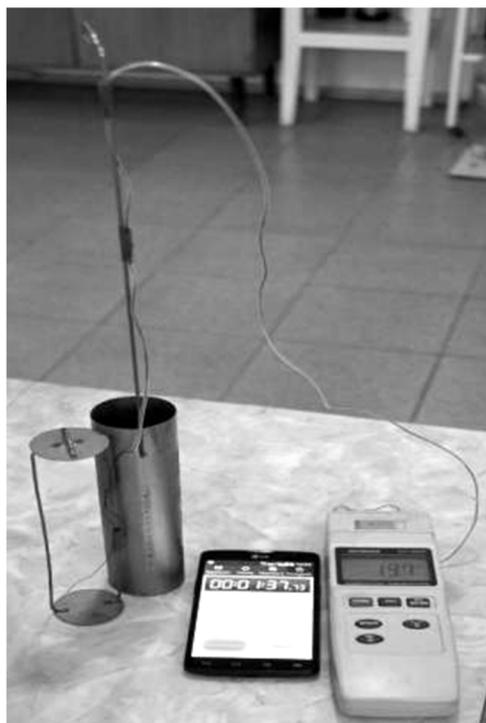
Рис. 1. Термометр с прикрепленной к стакану термопарой и секундомер
