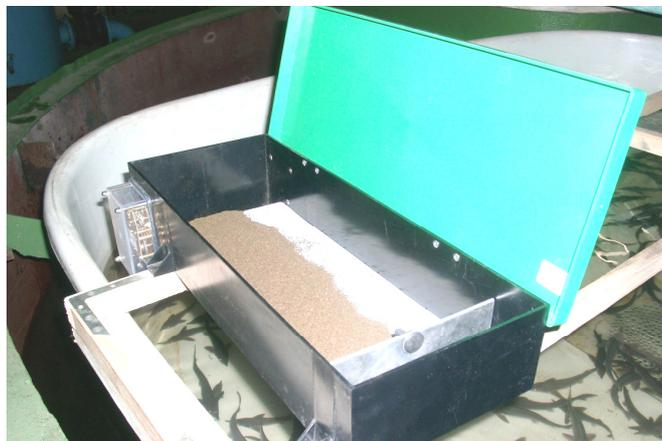
Рис. 3. Ленточная автоматическая кормушка FIAR
