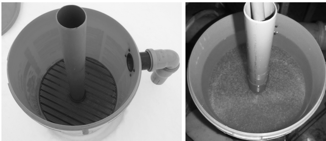
Рисунок 1 - Инкубационный аппарат для икры форели: слева – пустой аппарат, справа – аппарат с икрой
