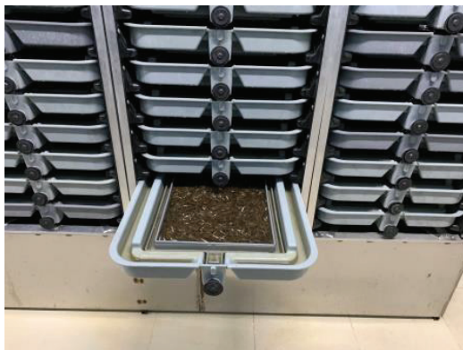
Рис. 3. Вертикальные инкубационные аппараты на ЛРЗ Лазовой
