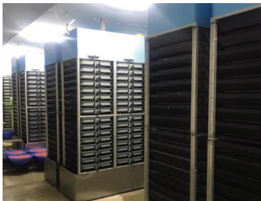
Рис. 3. Вертикальные инкубационные аппараты на ЛРЗ Лазовой
