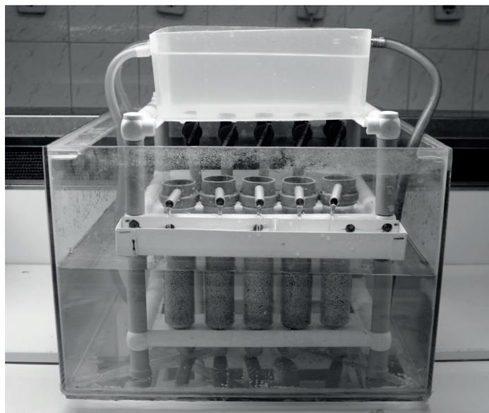
Рисунок 4 — Инкубация икры в аппаратах малого объема в лабораторной установке с замкнутым циклом водоснабжения
