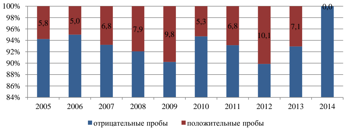
Рисунок 6.3. - Результаты исследования сточных вод после очистки на выходе из канализационных очистных сооружений Тюменской области, % положительных проб
