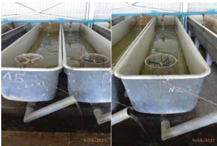
Рис. 3. Опытные лотки с кюветами в нижнем инкубационном цеху [Fig. 3. Experimental trays with cuvettes in the lower hatchery]
