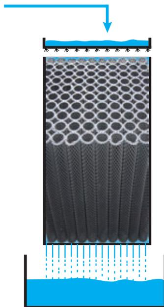
Иллюстрация 2.13 Фотография капельного фильтра, обернутого синей пластмассовой пленкой для избежания брызг на полу. Такой процесс аэрации/зачистки также называют процессом  $CO_2$ -зачистки. Как правило, наполнитель в капельном фильтре обычно бывает того же самого типа, который используется в биофильтрах с неподвижным наполнителем – см. иллюстрацию 2.10.
