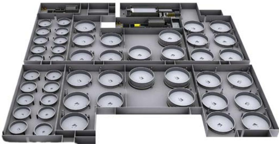
Иллюстрация 8.5 Трехмерный рисунок мегахозяйства с бассейнами диаметром 15 метров, объем каждого из которых может достигать более 500 м<sup>3</sup>.
