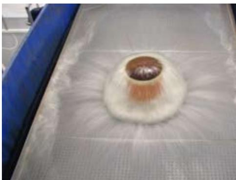
Иллюстрация 5.1 Качество и течение воды в фильтрах и рыбоводных бассейнах должны часто контролироваться визуальным способом. На фотографии изображена верхняя поверхность традиционного капельного фильтра, откуда вода стекает вниз по заполнителю фильтра.
