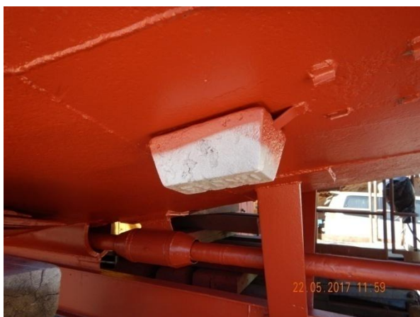
Рис. 3. Замененный (новый) протектор перед спуском судна на воду (днище в кормовой части)
