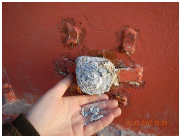
Рис. 2. Сохраненный (эксплуатировавшийся ранее) протектор после завершения навигации (перо руля)
