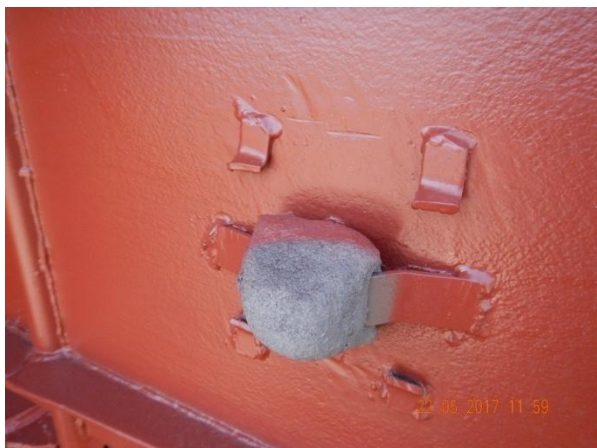
Рис. 1. Сохраненный (эксплуатировавшийся ранее) протектор перед спуском судна на воду (перо руля)
