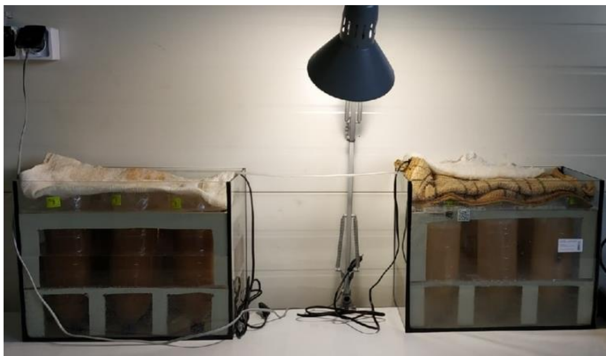
Рисунок 3 – Опытная установка для обогащения науплиусов артемии; АО ЮРЗ, 2020 г.
