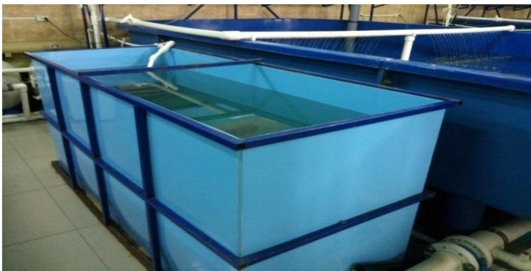
Рисунок 8. – Отстойник
