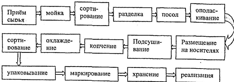
Рис. 2. Технологическая схема производства рыбы холодного копчения
