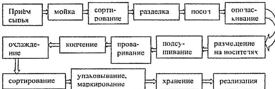
Рис 3 Технологическая схема производства рыбы горячего копчения
