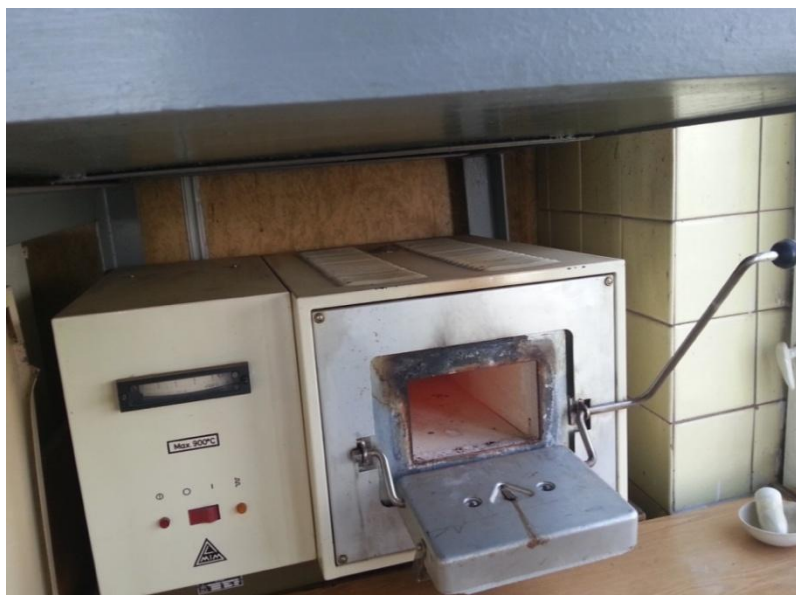
Рисунок 14 – Муфельная печь для сжигания образцов с нагревом до 900 °С (фото – Пырсигов А.С.)
