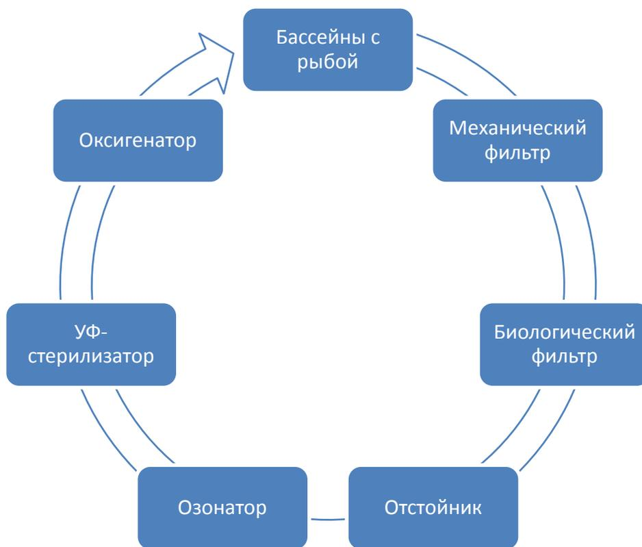
Рисунок 3. Принципиальная схема УЗВ
