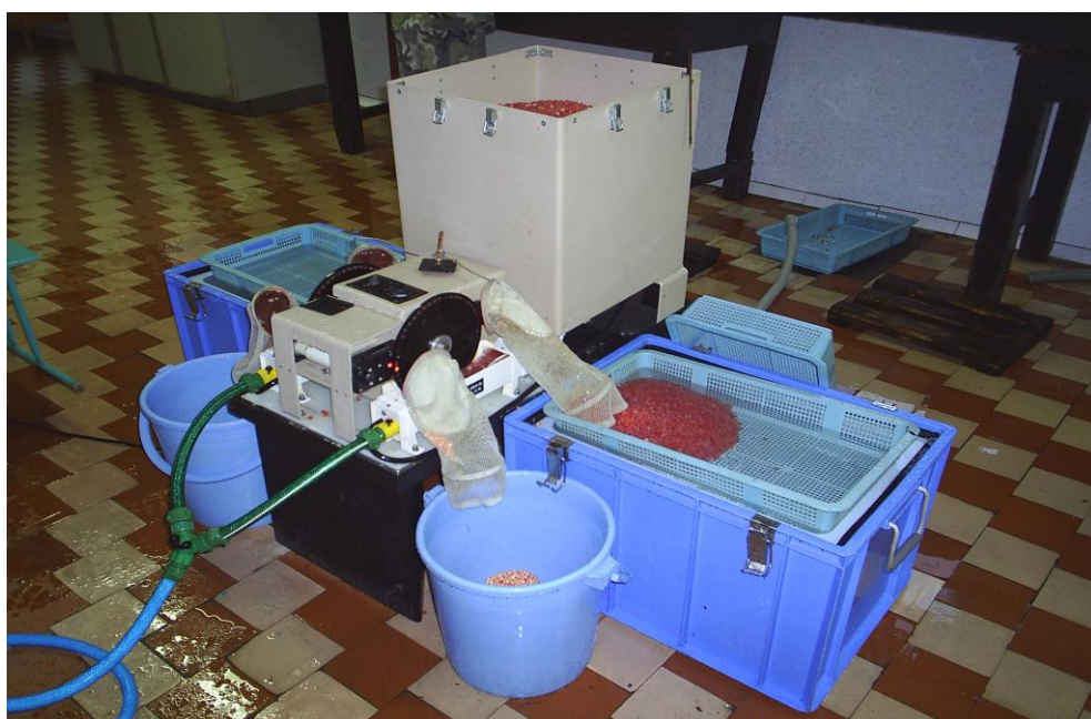
Рисунок 28 – Икроотборочный аппарат типа JX, Таранайский ЛРЗ
