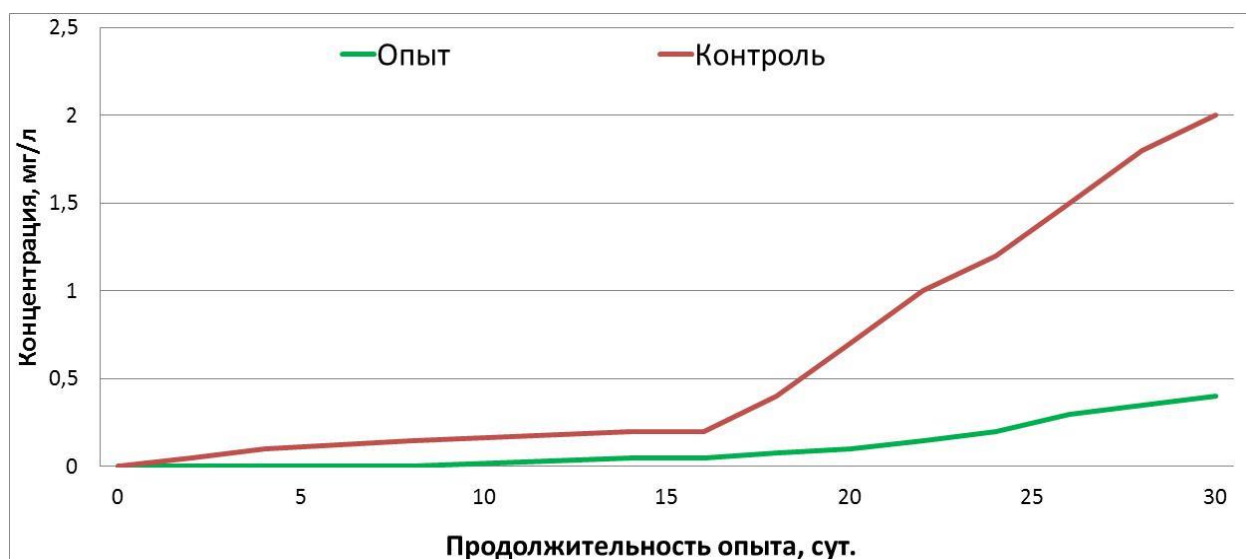
Рис. 44. Динамика концентрации фосфатов ( \text{PO}_4^{3-} ) в системе с водорослями (опыт) и без них (контроль)
