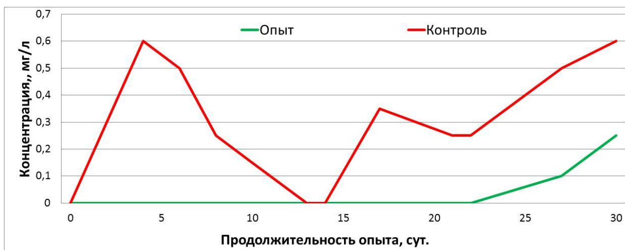
Рис. 37. Динамика концентрации нитритного азота ( \text{NO}_2^- ) в системе с водорослями (опыт) и без них (контроль)
