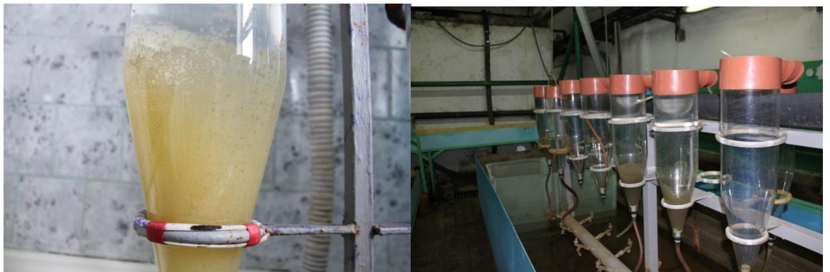
Рисунок 7. Инкубация икры вырезуба в аппаратах Вейса
