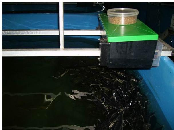
Рисунок 19 – Автокормушки ленточного типа с часовым механизмом в бассейновом цехе
