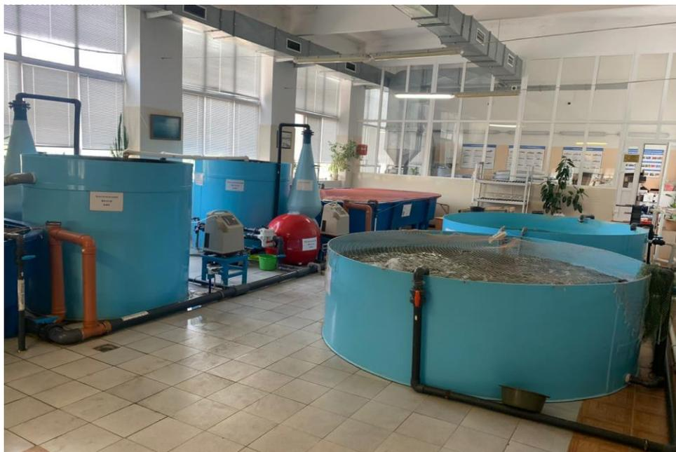
Рисунок 4 - УЗВ (установка замкнутого водоснабжения) ПНИЛ «Разведение ценных пород осетровых» ФГБОУ ВО Волгоградского ГАУ
