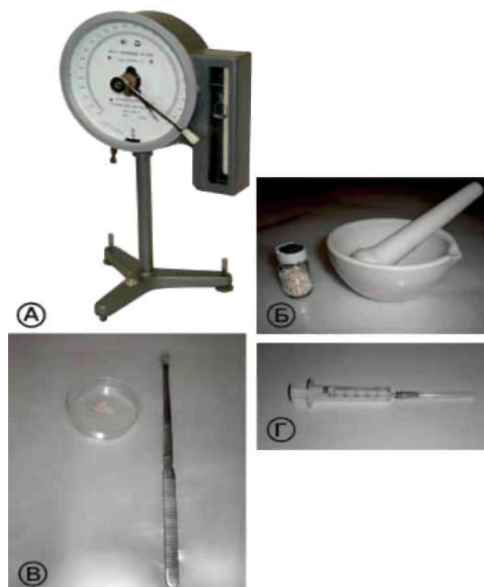
Рисунок 9 - Оборудование и материалы для приготовления суспензии гипофиза: А – торсионные весы; Б – ступка и пестик для растирания гипофизов; В – растёртый гипофиз; Г – шприц для инъекций.
