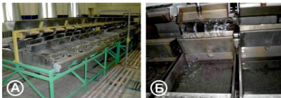
Рисунок 24 - Инкубационный аппарат «Осетр»: А – одна из сторон аппарата; Б–инкубационные ящики аппарата «Осетр» в период инкубации икры белуги.
