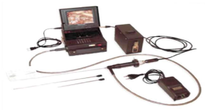
Рисунок 7 - Эндоскопическая система для определения пола и стадий зрелости
