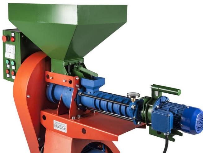
Рисунок 5.12 – Экструдер
