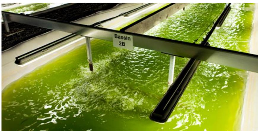
Рисунок 8.16 – Культиватор микроводорослей
