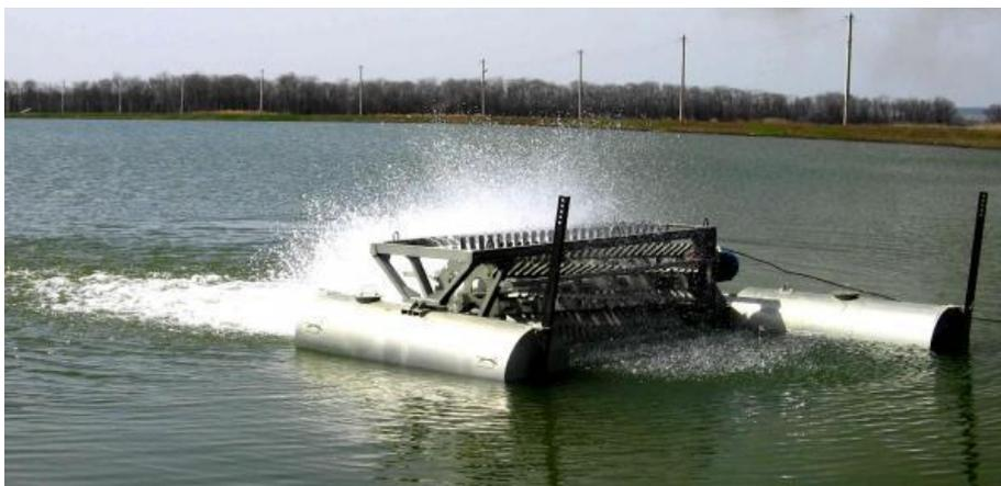
Рисунок 6.37 – Механический аэратор «Ерш» с горизонтальным барабаном
