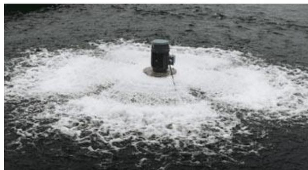
Рисунок 6.38 – Схема и внешний вид механического пропеллерного аэратора «Винт»
