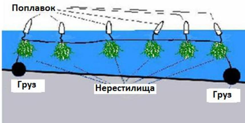
Рисунок 9.3 – Схема расположения искусственных нерестовых гнезд
