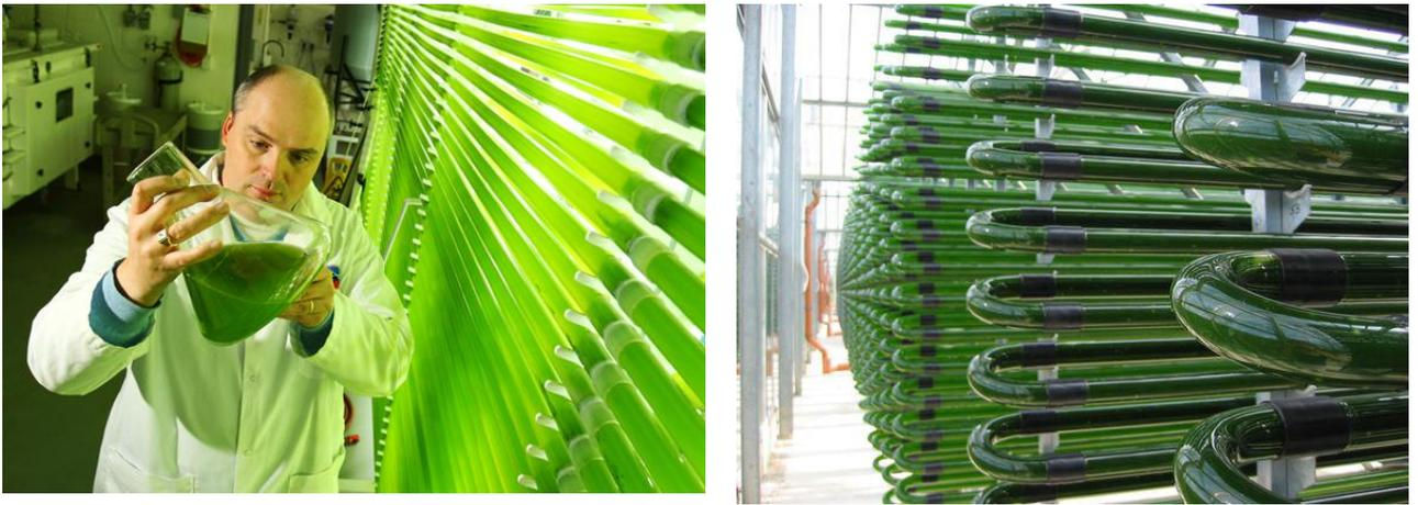
Рисунок 8.17 – Трубчатый фотобиореактор
