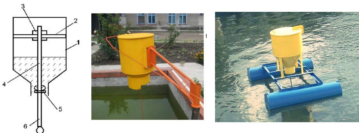
Рисунок 6.23 – Схематическое изображение и внешний вид кормушек «Рефлекс»
