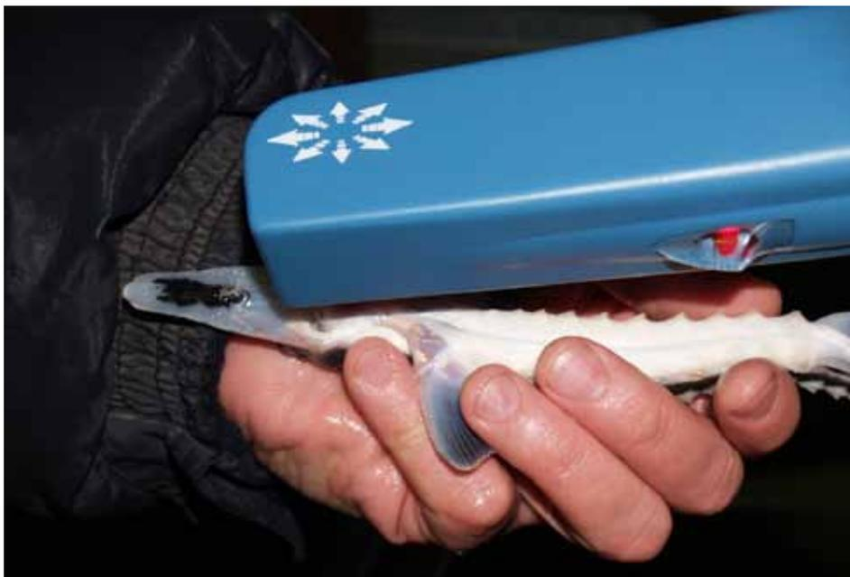
**Рисунок 131:** Обнаружение намагниченной SWT-микрометки специальным детектором.
