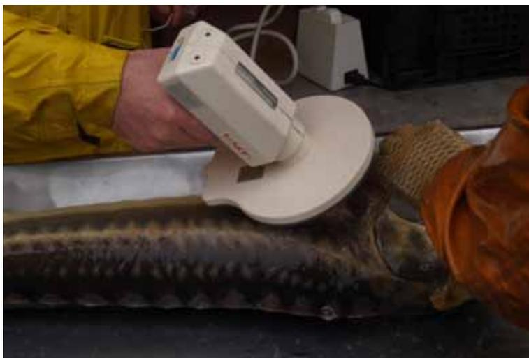
**Рисунок 129:** Портативный ручной детектор (ридер) для считывания ПИТ-меток.
