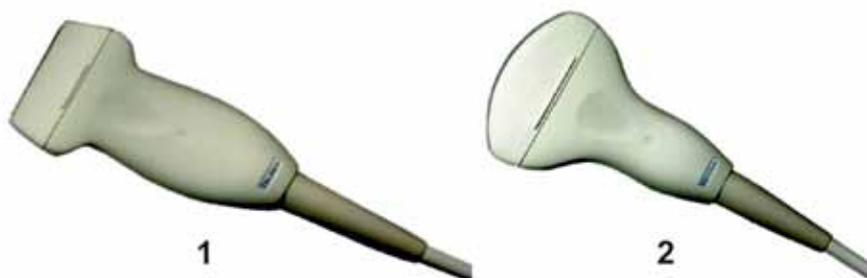
**Рисунок 132:** УЗИ датчики: 1 - линейный, 2 - конвексный.
