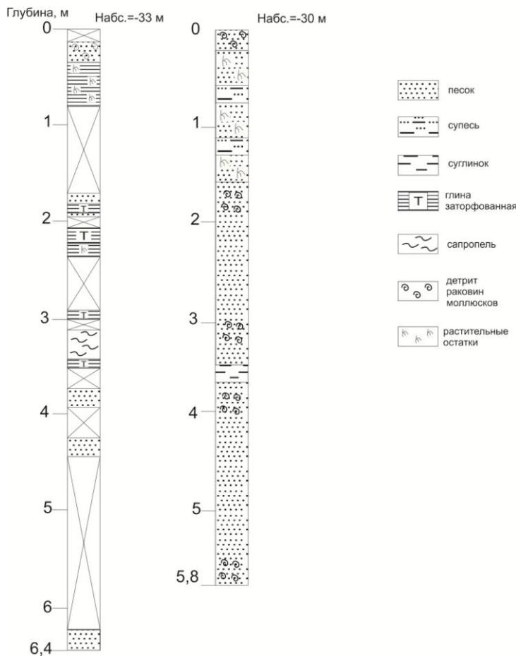
Рис. 3.11. Керн скважин Рыбачье-1 и Zb-1 (структуры Рыбачья и Жамбыл соответственно).
