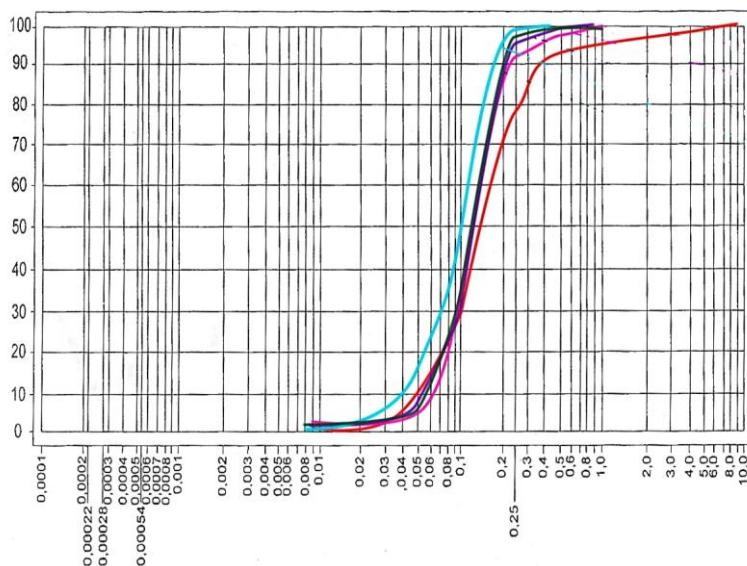
Рис. 7.25. Пример кумулятивных кривых образцов из бугровых отложений
