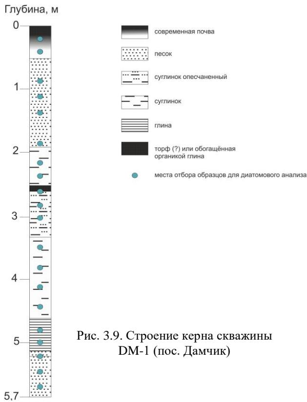
Рис. 3.9. Строение керна скважины
