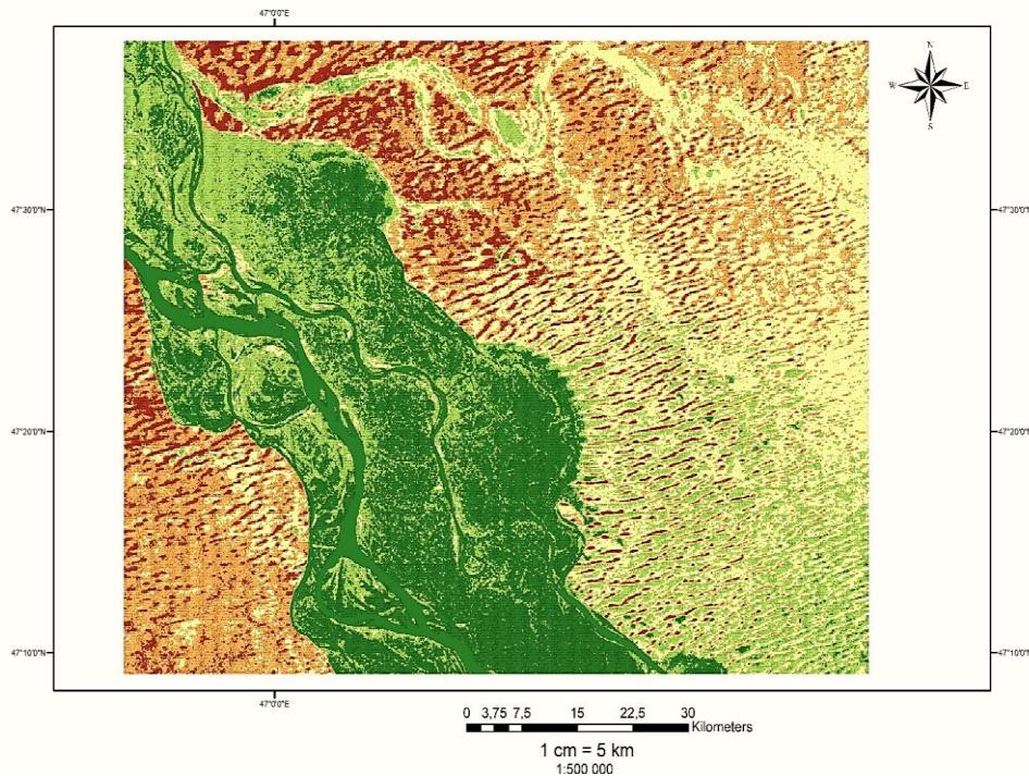
Рис. 7.6. Участок с развитым рельефом ББ в районе пос. Селитренное – Сероглазовка (средняя часть нижнего течения Волги). Хорошо прослеживаются гряды и их ориентировка, а также палеопротоки Волги. Источник ЦМРП SRTM3 (применение операции hill shade), (выполнила Лобачева Д.)
