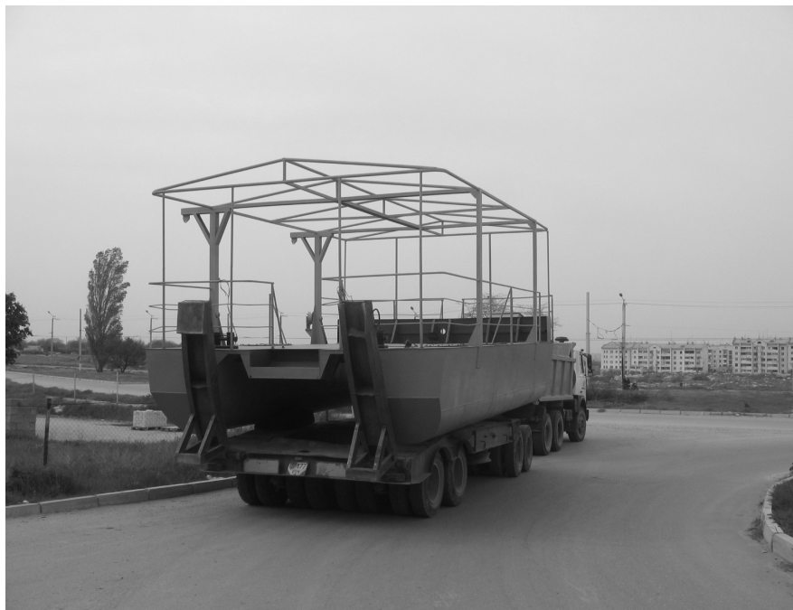
Рис. 76. Катамаран конструкции ИнБЮМ – ПКБ «Корвет Юг» на автомобильном прицепе. Вид с кормы: видны два портала и два рола, установленные вдоль левого борта.
