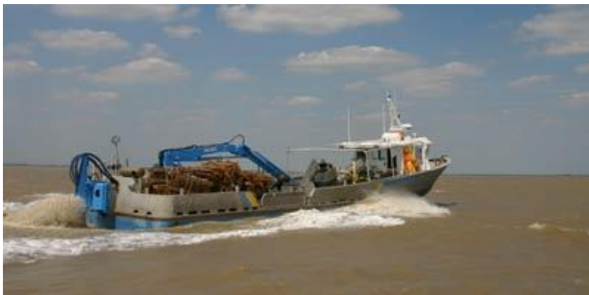
Рис. 79. Судно плавбаза для работы с подповерхностными носителями и обработки мидий в открытом море (Франция).
