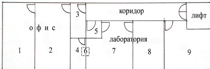
Рис. 132. План 3-го этажа: 1 – кабинет директора; 2 – делопроизводство; 3 – прихожая; 4 – подсобная; 5 – прихожая лаборатории; 6 – умывальник; 7 – помещение для влажных работ; 8 – приборная; 9 – склад.
