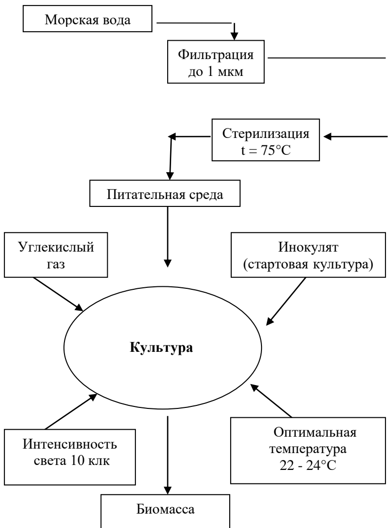
Рис. 120. Схема подготовки питательной среды и массового культивирования микроводорослей.
