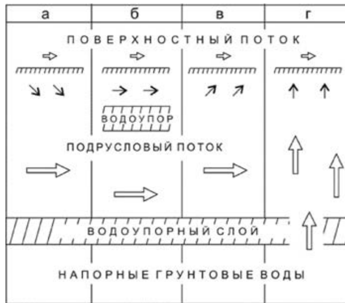
Рис. 18. Фильтрационный режим в грунте типичных нерестилищ лососевых рыб и вертикальная зональность подземных водоносных горизонтов: а — инфильтрация речных вод в дно русла (горбуша, чавыча, сима); б — участки с горизонтальной фильтрацией воды в речном грунте (нет нереста); в — выходы вод подруслового потока (кета); г — выходы напорных грунтовых вод (кета, нерка, кижуч) (Леман, 2003)
