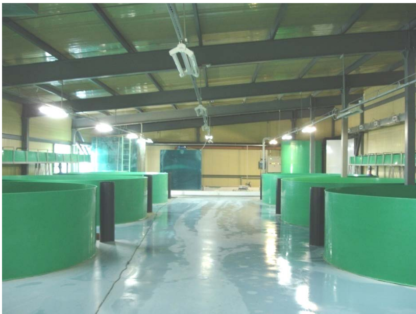
Рис. 35. Внешний вид установки для подращивания молоди до массы 5 г
