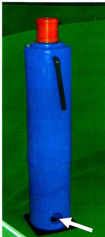
Рис. 47. Выход воды, насыщенной кислородом
