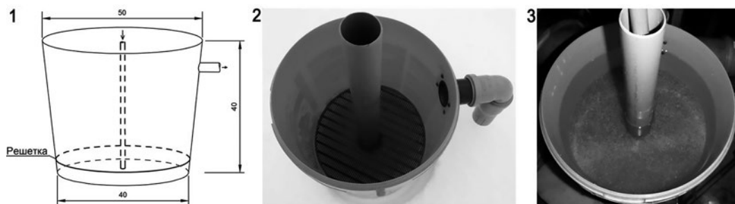
Рис. 5. Инкубационный аппарат для икры форели: 1 – схема; 2 – пустой аппарат; 3 – аппарат с икрой
