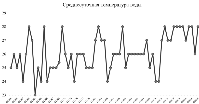
Рис. 2. Температурный режим в бассейнах тепличной аквапонной установки
